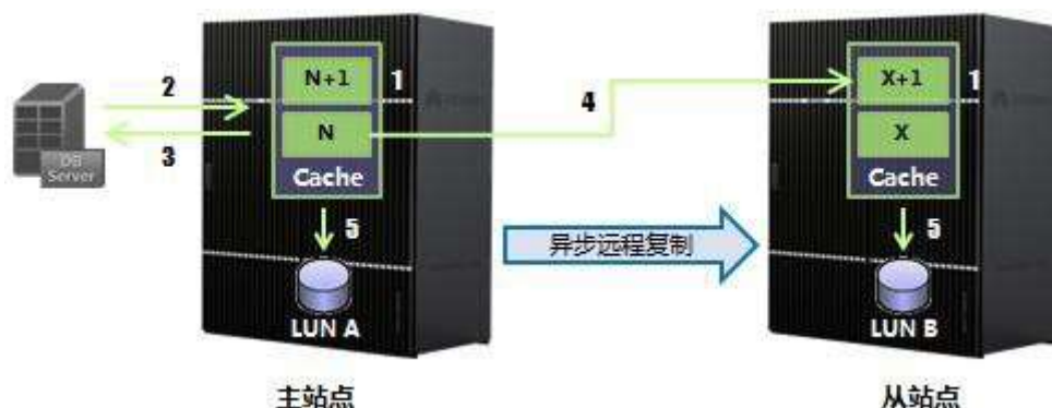
图3-6 LUN 异步远程复制原理
